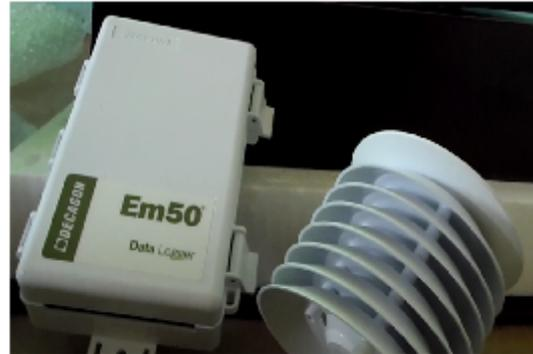
Figure 8 : Acquisiteur de données et sonde thermique extérieure de DECAGON DEVICES
